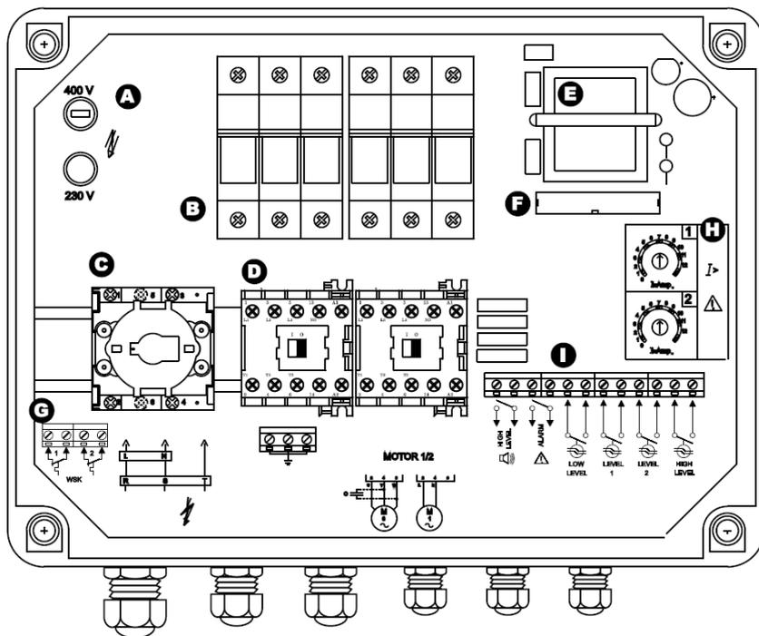
Vérifier que tous les raccordements soient correctement effectués et que le fusible de choix de tension soit bien positionné (230 ou 400 Vac).
