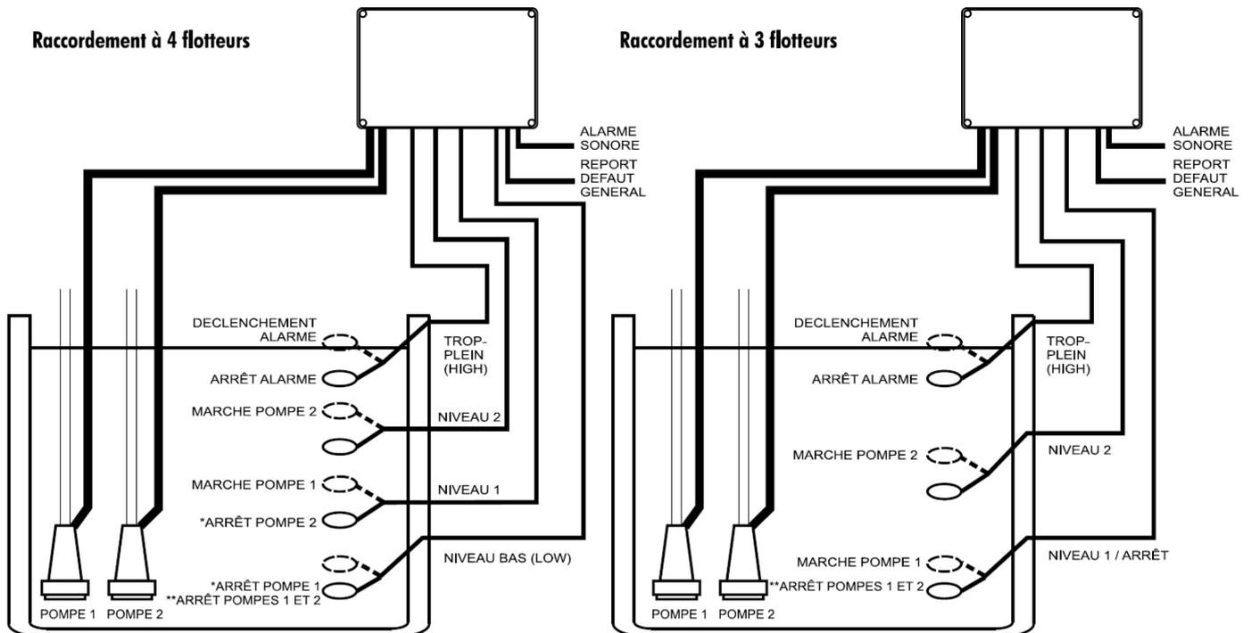
\*Mode de fonctionnement sur "ARRET DIFFERE" (Pos. B)
